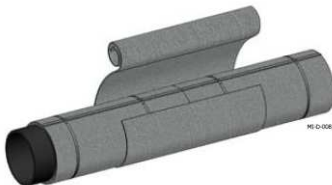
Imagen2: Instalación de la segunda capa en la tubería.
