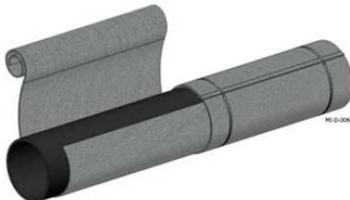
Imagen1: Instalación de la primera capa de la tubería.
